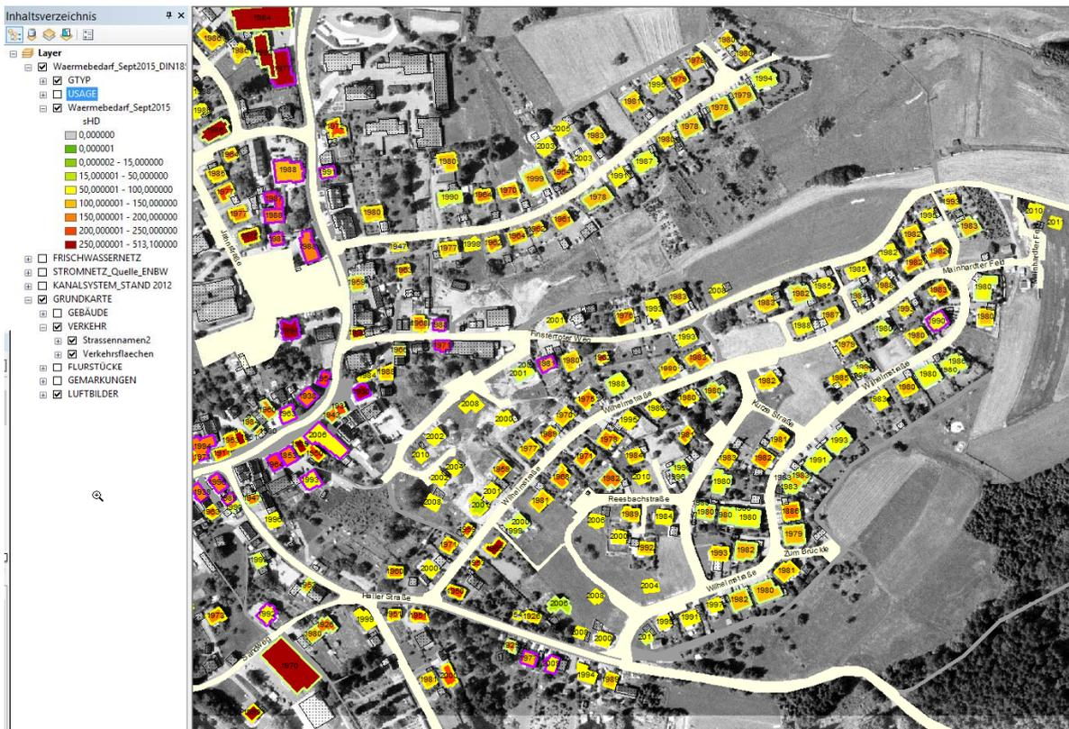
Abbildung 3: Simulierter Jahres-Heizwärmebedarf in einem Ausschnitt des virtuellen Stadtmodells
