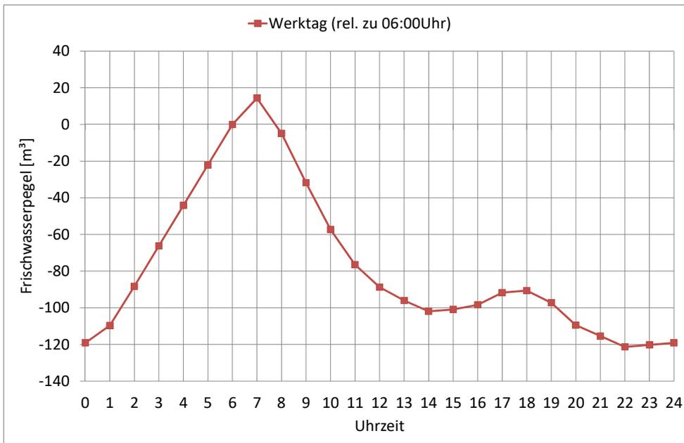
Abbildung 7: Bilanzlinie des Wasservorrats unter der Annahme gleichmäßiger Zuspeisung und des Abnahmeprofiles nach Abbildung 6
